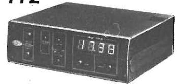
Concepito principalmente per l'accensione e lo spegnimento programmato di impianti di diffusione sonora. Può tuttavia essere usato per moltissime altre applicazioni. Alimentazione: 220 Vc.a. 50 Hz. Corrente assorbita: 350 mA c.a. Massima corrente commutabile: 5 A - 220 V (carico resist.) Display orologio: 24 ore. Regolazione indipendente delle ore e dei minuti.
